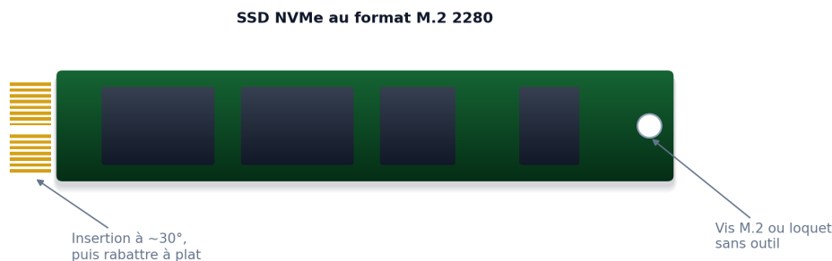
Illustration 2.3 — SSD M.2 : insertion inclinée à ~30°, puis rabattement et fixation.
