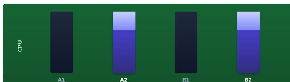
Illustration 5.2 — Population typique pour un kit de 2 barrettes (double canal) : slots A2 + B2. Toujours confirmer dans le manuel de la carte.
