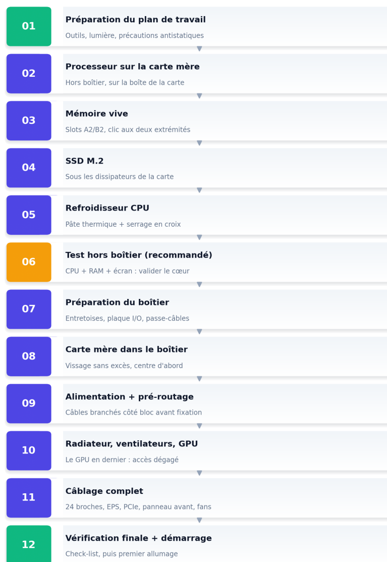
Illustration 5.1 — Les 12 étapes du montage, dans l'ordre recommandé.
